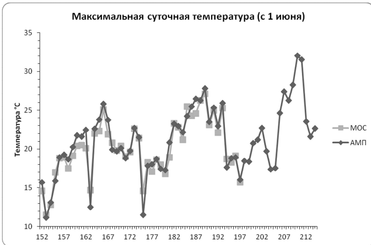
Рис. 2. Сравнение экспериментальных значений максимальных температур, полученных на Меньковской опытной станции (МОС) и на АМС
